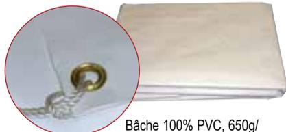
Bâche 100% PVC, 650g/m<sup>2</sup> de couleur blanche. Finition traitement laqué lisse sur une face. Oeillets Ø28mm en laiton avec cordelette blanche Ø5mm x 1,5m. Résistance à la température -30°C / +70°C. Étanche, elle permet de protéger efficacement et durablement contre les intempéries.
