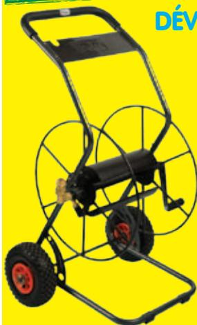
Dévidoir semi Pro monté sur de 2 roues increvables. Idéal pour un usage régulier. Capacité de 85m en diamètre 19mm et 50m en diamètre 25mm. Poignée haute ergonomique avec élastomère pour une meilleure prise en main. Très bonne stabilité grâce à son cadre incliné vers l'avant. Blocage du dévidoir possible. Raccords en laiton. Tambour avec flasques pour une plus grande solidité, monté sur roulements.
