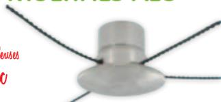
Tout alu, s'adapte sur 100% des débroussailluses sup. à 35cc. Alésage de 20 ou 25,4mm. Utilisable avec 2 ou 4 fils de 3,3 à 4,7mm.
